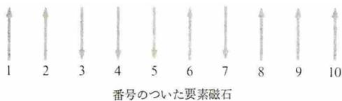
図 1・3 一直線上の定点にある要素磁石で構成されているモデル系、各基本磁石は磁気モーメント  $\pm m$  をもつ。示した数字は座席の番号であり、各座席に磁石が存在する。磁石間の相互作用は存在しない。また外部磁場も作用していない。各磁気モーメントは上向きと下向きと 2 つの方向をとることができるので、図に示した 10 個の磁気モーメントについては  $2^{10}$  個の異なる配列が存在する。配列がまったく任意であるとすれば、系が特定の配列に見いだされる確率は  $1/2^{10}$  である。
