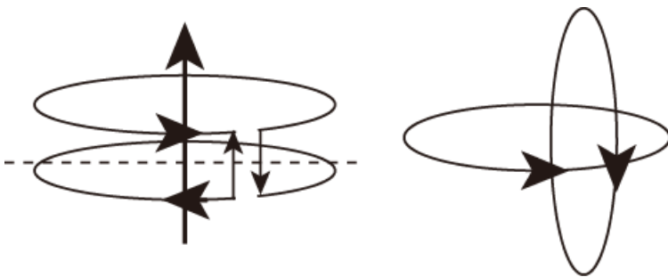
図 1.10: 図左では回転成分がキャンセルする。これは絡みがないのと同等である
